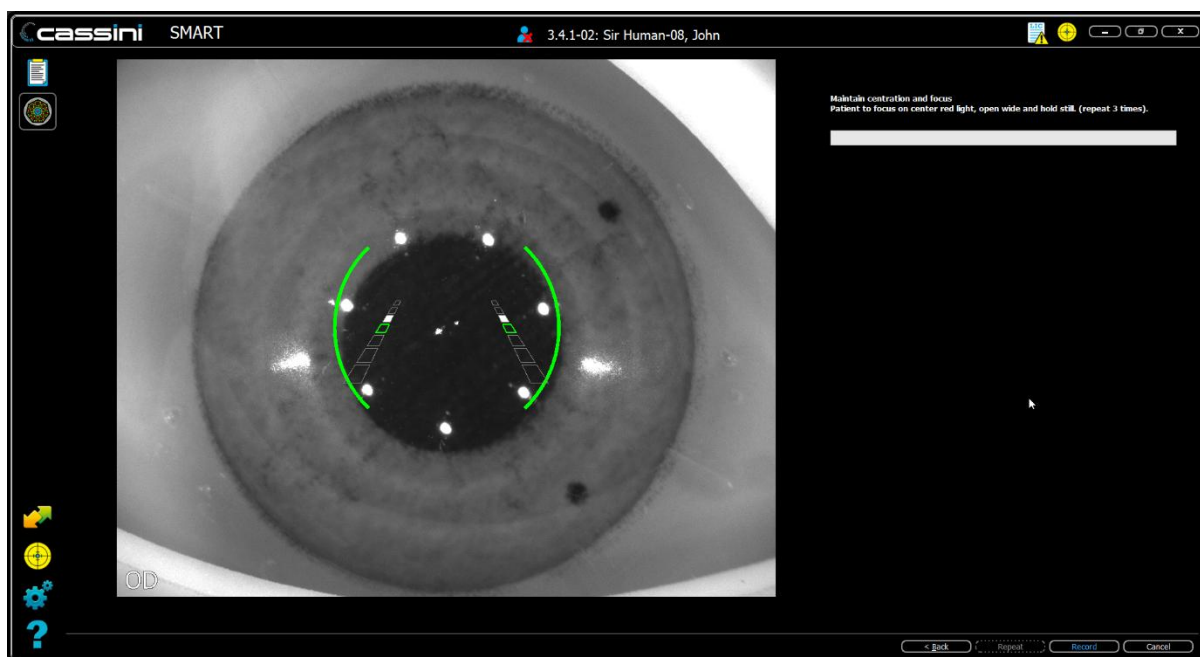
Figure 30 : Reflet des 7 LED infrarouges visible et non bloqué par le nez ou les sourcils. Les rails de mise au point doivent être verts
