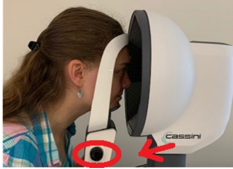
Şekil11: Hasta konumlandırması ve çene dayanağı ayar düğmesi
